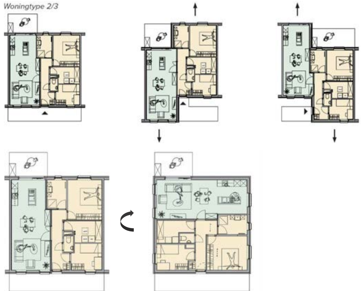
Fig.: Woon eenheid type 2/3 kan eenvoudig gedraaid worden mits beperkte aanpassingen van de binnenwanden en ruimten.
